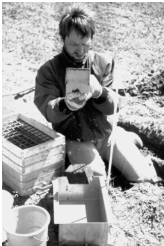
Måling af jordens evne til at smuldre ved bearbejdning måles ved at lade en udtaget prøve falde frit fra 75 cm højde. Der måles størrelsesfordeling af knolde/krummer.
